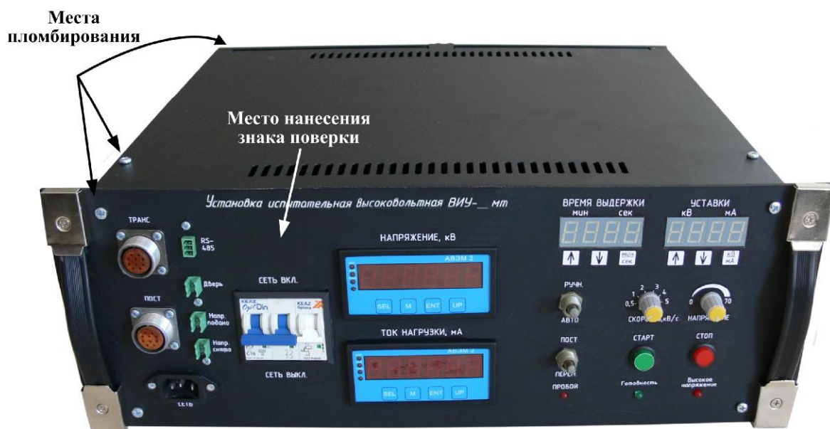
Рисунок 2 – Общий вид блока контроля и управления и схема пломбировки от несанкционированного доступа
