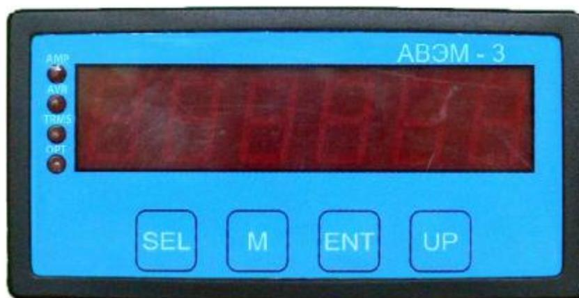
Рисунок 2 – Прибор измерительный АВЭМ-3. Передняя панель.
